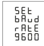
Para variar el la velocidad de transmisión de periférico se pulsa repetidamente la tecla **MAX**, variando el valor de las diferentes opciones de comunicación.
