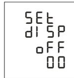
Indica el tiempo del protector de pantalla (*en segundos*), desconectando el Backlight.
