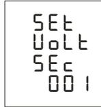
Para escribir o modificar el valor del secundario del transformador se pulsa repetidamente la tecla **MAX**, incrementando el valor del dígito que está parpadeando en aquel momento.
