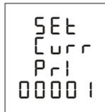
Para escribir o modificar el valor del primario del transformador se pulsa repetidamente la tecla **MAX**, incrementando el valor del dígito que está parpadeando en aquel momento.
