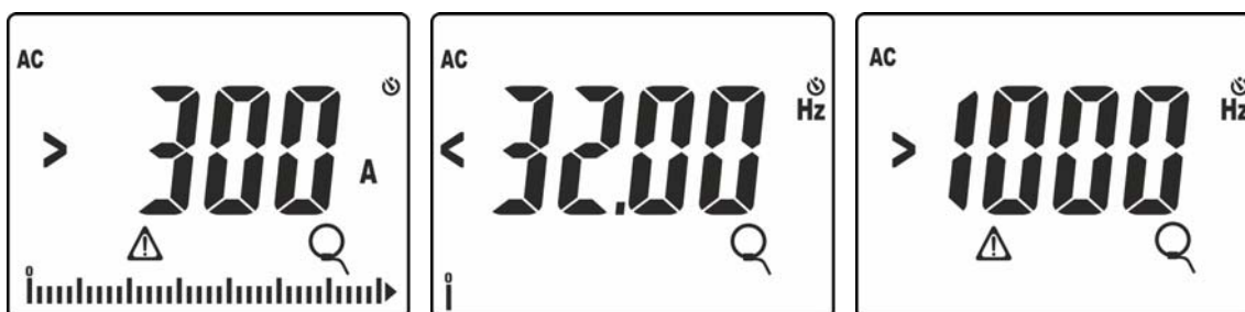
Fig. 41: Situaciones anómalas sobre la medida de corriente con transductores de pinza
